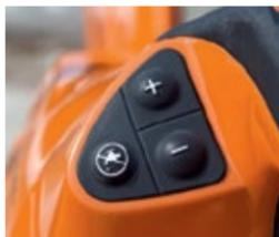
**REGULACIÓN ELECTRÓNICA DEL AGUA (A)**
